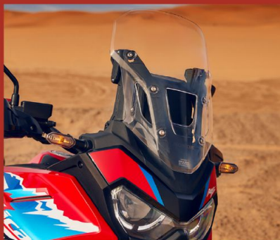
ライダーのポジションに合わせて調整可能な5段階調整式スクリーン
