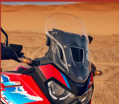
ライダーのポジションに合わせて調整可能な5段階調整式スクリーン
