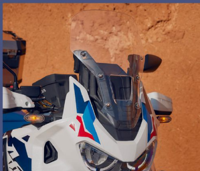
ライダーのポジションに合わせて調整可能な5段階調整式ロングスクリーン
