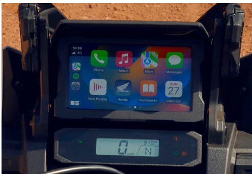
6.5インチタッチパネルのマルチインフォメーションディスプレイ
