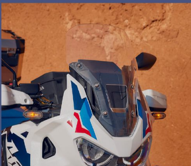
ライダーのポジションに合わせて調整可能な5段階調整式ロングスクリーン
