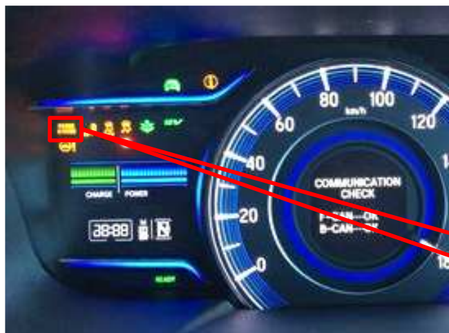
パワーシステム警告灯
