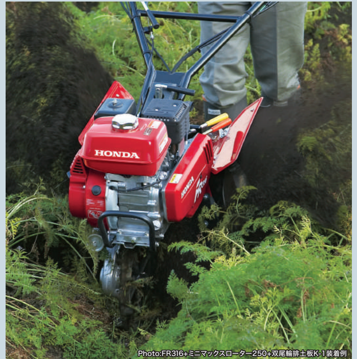
Photo:FR316+ミニマックスローター250+双尾輪排土板K-1装着例
